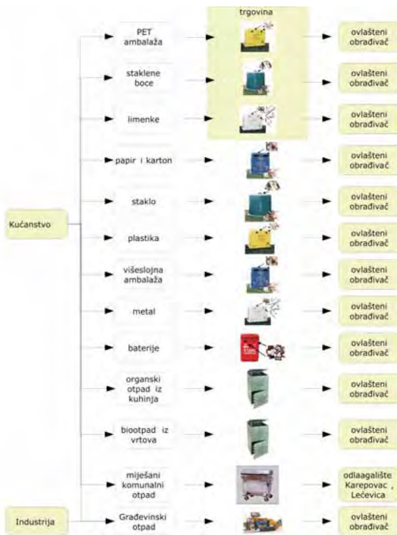
Slika 10. Mjere primarne reciklaže
