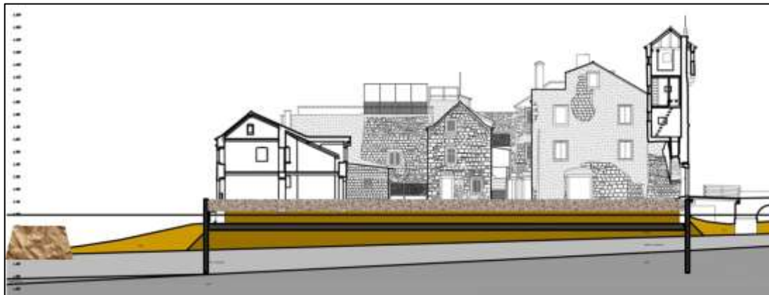
Slika 4.3 Primjer zaštite utvrđenih objekata na samom moru: podpovršinski razbijač valova za smanjenje vala, vodonepropusne membrane ispod i oko
